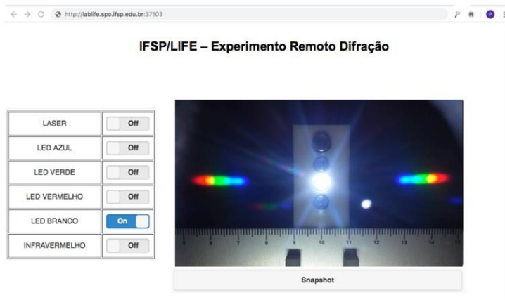
Figura 4. Imagem da experimentação remota, difração Led RGB para L = 10,0(5)\text{cm} .
